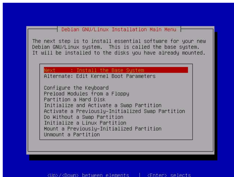
Εικόνα 30 Εγκατάσταση βασικού συστήματος
